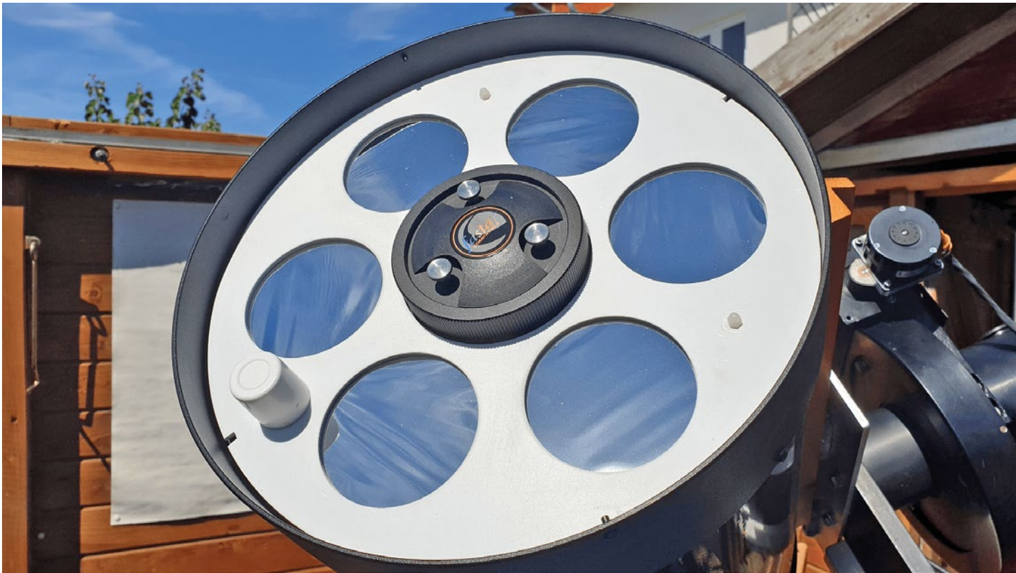
4 Die komplett montierte Filterhalterung am Celestron 11. Der weiße ‚Knubbel‘ links unten dient als Griff, um die Filterhalterung einfacher aufzusetzen bzw. abzunehmen.
