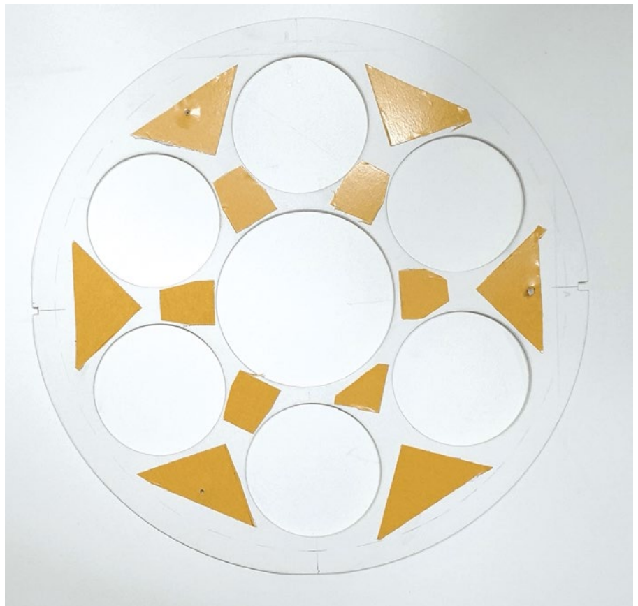
1 Die fertig ausgeschnittene Basisplatte mit den aufgeklebten Abschnitten aus Teppichklebeband, hier noch mit gelber Schutzfolie
